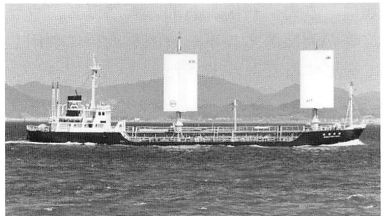
オイルショックの後の1980年代には、たくさんの帆装商船が登場した。
