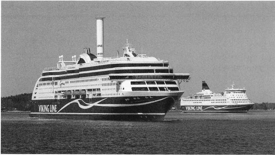
2010年代後半から再び省エネのための帆装がブームになっている。LNG燃料を使い、ローターセールも装備したバルト海のクルーズフェリー「バイキンググレース」(写真：バイキングライン提供)
